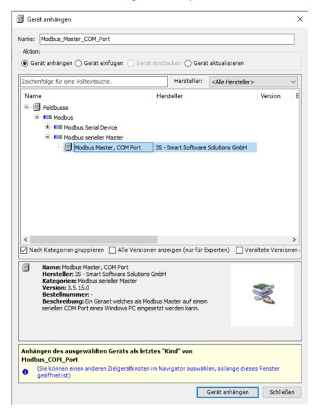
Figure 38: CODESYS - Add Modbus master
